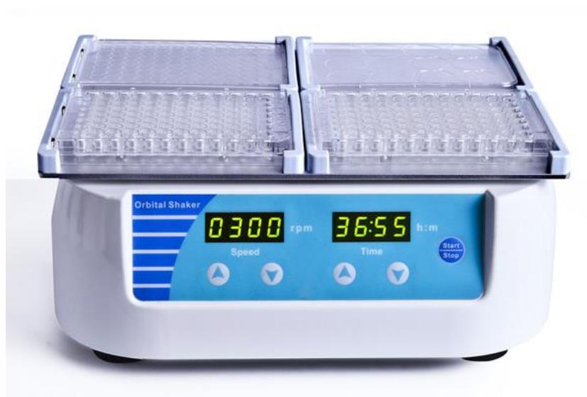
ChromTech® MPS-1500 微孔板震盪器採用直流無刷電機驅動震盪，主要用於酶標板（96孔/384孔板）、細胞培養板（24孔板、48孔板、96孔板等）等溶液進行混勻震盪。可應用於免疫測定和染色等實驗，可在室溫低的環境或培養箱中使用，產品外觀大方，操作簡潔方便，安全穩定無噪音。
