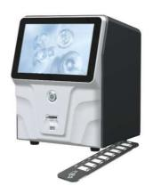
AC-8 是一台全自動的細胞計數和分析儀器,內置光學成像系統和圖像分析演算法,可對培養細胞的多種參數進行準確分析。儀器需要搭配專用的八孔細胞計數板進行使用,在最快 40 秒內完成 8 個樣品的濃度、活率、直徑和團聚率等細胞參數的分析及自動保存資料,並且可以透過多種格式檔案輸出。檢測時採用一次性計數板,可避免樣品交叉污染。
