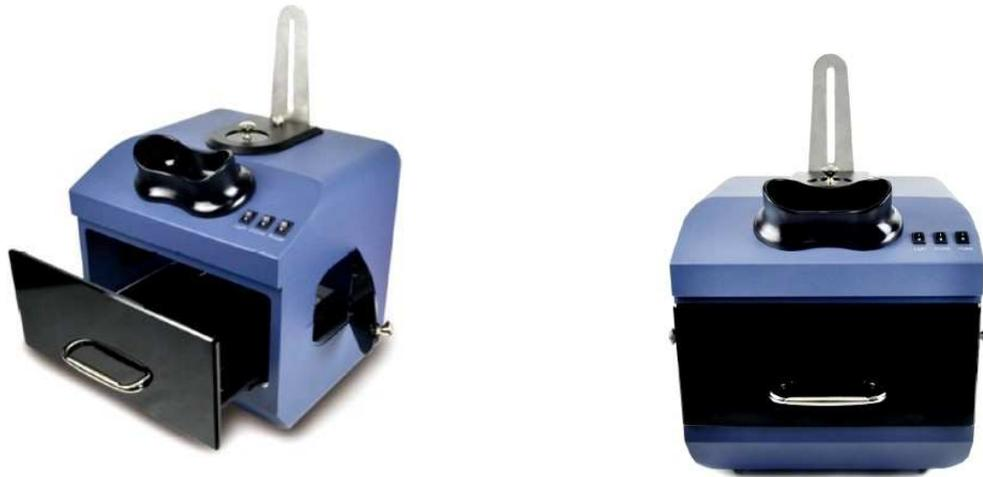
暗箱式紫外分析儀可發出長/短波紫外線，紫外線強度高、穩定性好、使用方便可靠。主要用在生物化學對 DNA、RNA 電泳凝膠樣品進行觀察分析，檢測蛋白質、核苷酸等。
