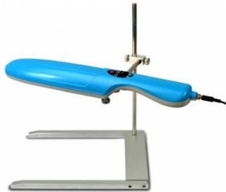
UV-6 紫外分析儀輻射波長為 365nm 和 254nm 或波長為雙 365nm 或雙 254nm。它們被用來在螢光染色劑下檢測核酸染料。手持紫外燈可用於多個領域的核酸檢查，包括分子生物學、生物化學、法醫檢驗及生物製劑等螢光方面的觀察。
