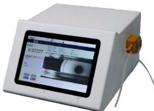
密度計是食品、日用化學品、藥品、香料、石油及其他液體樣品測試的必備儀器。採用振盪法原理，結合 Peltier 控溫技術和高清晰攝像技術，為使用者提供準確、穩定、可靠的測試結果。
