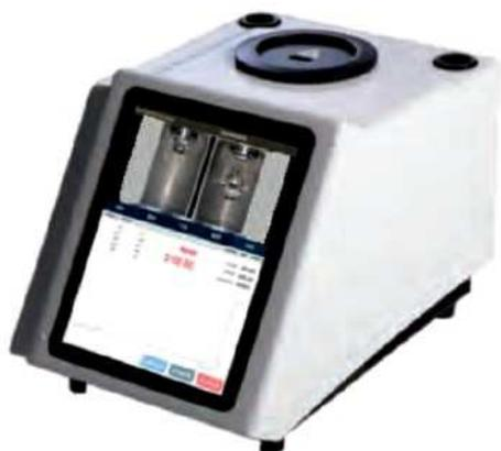
全自動滴點與軟化點測定儀為使用者提供準確、穩定、可靠的測試結果。攝像影片可看到樣品的狀態變化過程，自動檢測即時圖譜顯示，準確測得樣品滴點/軟化點。符合 GLP 規範及國際 ASTM/DIN 標準的測量方法。
