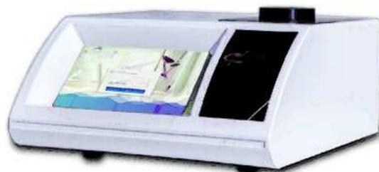
全自動折光儀可測量透明、半透明、深色、粘稠狀等各類液體的折射率 (nD) 和糖溶液的品質 (Brix)。廣泛應用於石油、油脂、製藥、食品、化工、製糖等工業，及相關的大專院校和科學研究院所的常用設備。
