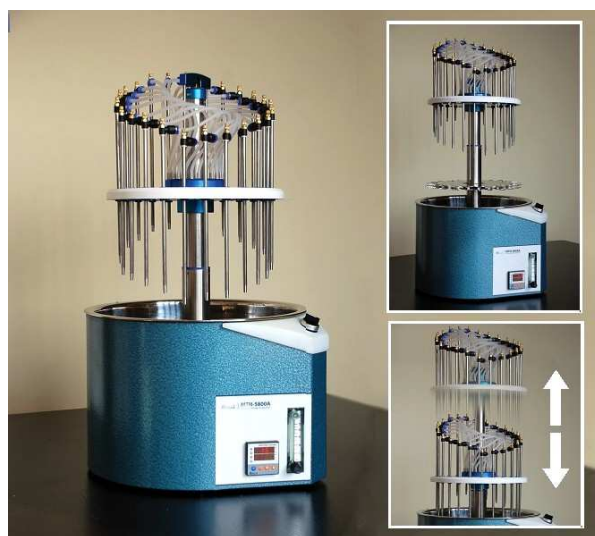
SC-5800A 自動升降吹氮濃縮加熱裝置
