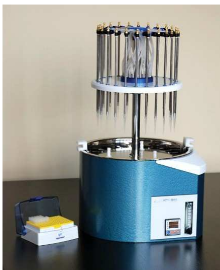
SC-5800 水浴型吹氮濃縮加熱裝置
